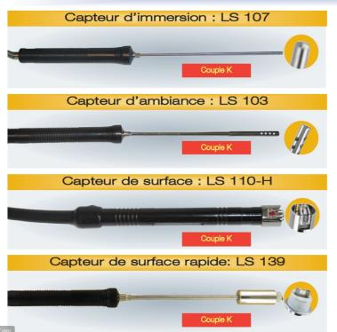
Thermocouple K d'immersion - usage générale Longueur 150 mm - diamètre 3 mm Poignée ABS - diamètre 17 mm Sortie câble spiralé de 1.8 mètres. Température d'utilisation : 700°C
