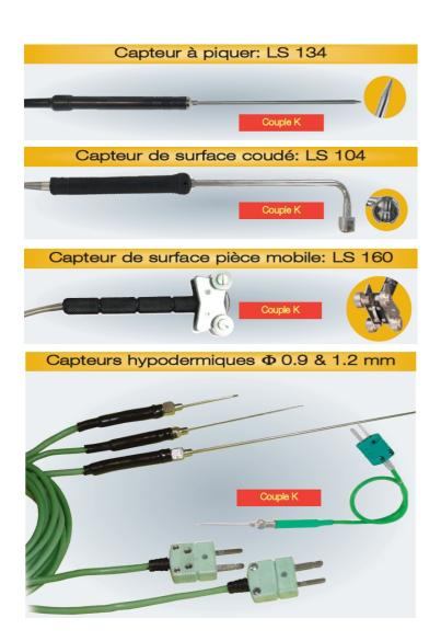
Thermocouple K à piquer Poignée ABS - diamètre 17 mm - longueur 130 mm Sortie câble spiralé de 1.8 mètres. Température d'utilisation : 600°C
