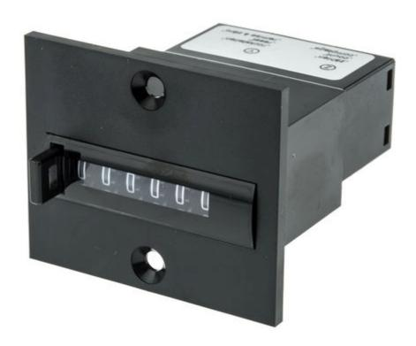
6 chiffres 4 mm, remise à zero manuel/pneumatique, 8 chiffres sans remise à zéro Pression 2 à 8 bar vitesse maxi 25 Hz Dimensions: 60x51x70 découpes 52 x 26 mm
