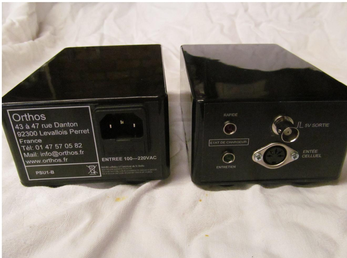
Bloc batterie sans affichage permettant de rentrer des imputions d'une cellule ou d'un détecteur de proximité et d'en obtenir un signal en 5 VTTL
